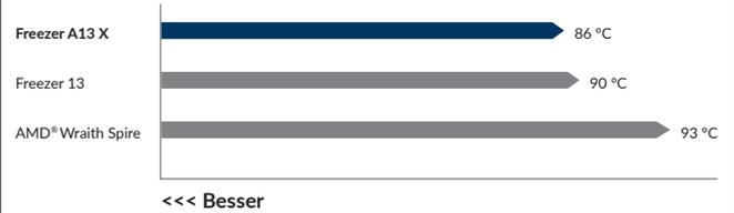
Getestet mit Prime 95 Small FFT in Standard Tower PC-Case, CPU Kühler auf voller Drehzahl
